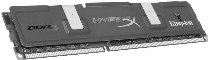
**Figura 20.** La memoria RAM del tipo DDR3 posee la ventaja de realizar transferencias de datos mucho más rápido que versiones DDR anteriores.
